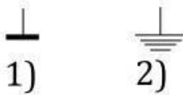
Рис. 1.11. "Корпус" (1) и "земля" (2) в электрических схемах
