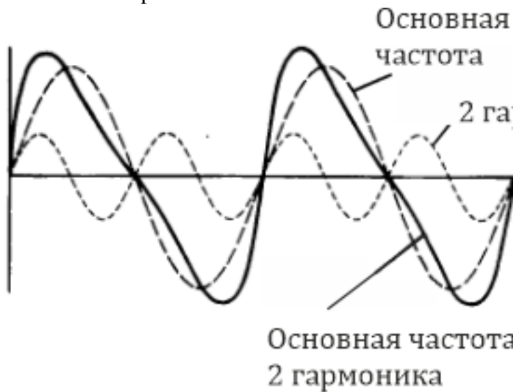
Рис. 2.21. Аппроксимация пилообразного сигнала
