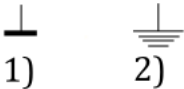
Рис. 1.11. "Корпус" (1) и "земля" (2) в электрических схемах
