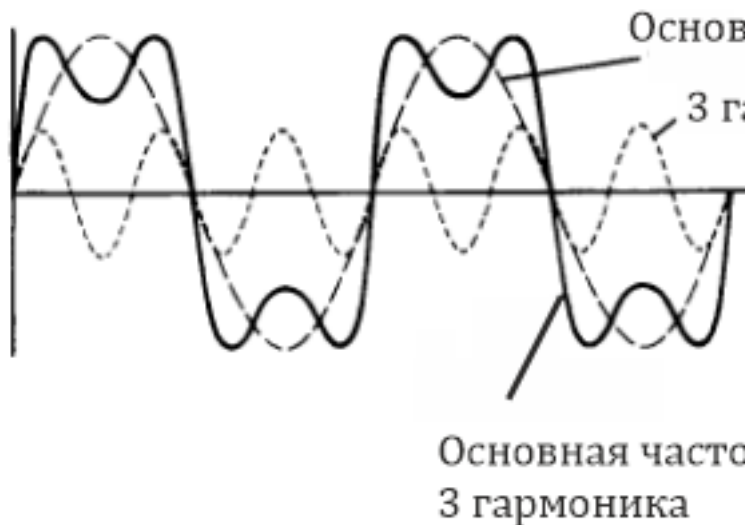
Рис. 2.20. Аппроксимация прямоугольного сигнала
