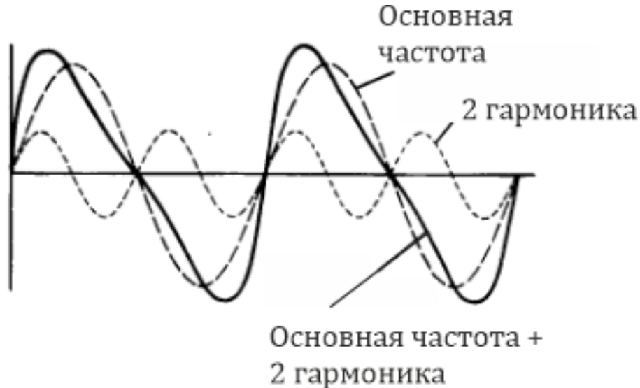
Рис. 2.21. Аппроксимация пилообразного сигнала
