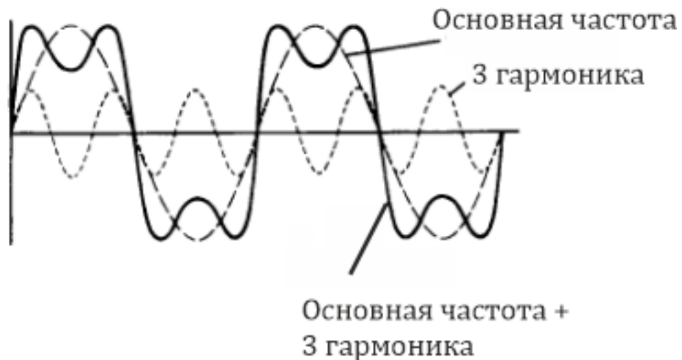
Рис. 2.20. Аппроксимация прямоугольного сигнала
