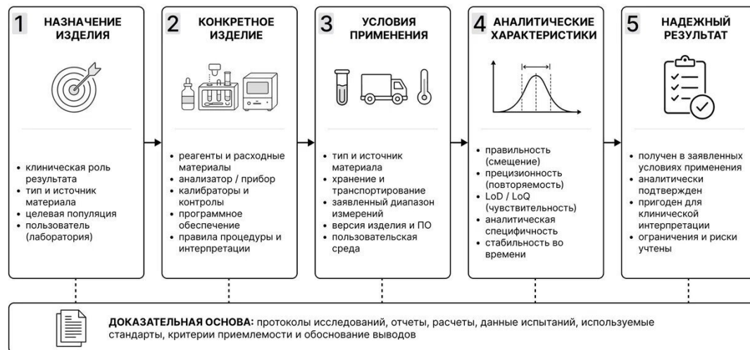
Рисунок 17.1. Аналитическая эффективность как подтверждение надежности результата конкретного изделия для диагностики in vitro
