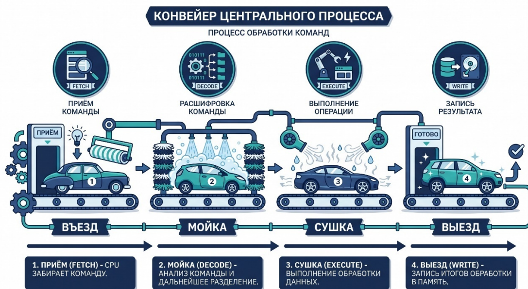
Рис. 2.1. Конвейерная обработка: четыре инструкции обрабатываются одновременно на разных стадиях.
