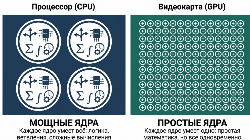
Рис. 2.3. CPU против GPU: несколько мощных ядер против тысяч простых.
