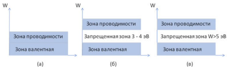
Рисунок 1.1 – Схемы зонной теории: (а) проводники; (б) собственные полупроводники; (в) диэлектрики
