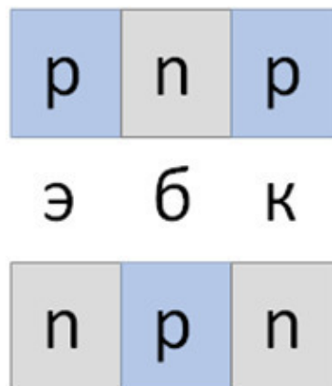
Рисунок 1.5 – Структура двух типов биполярных транзисторов: рпр и прп.
