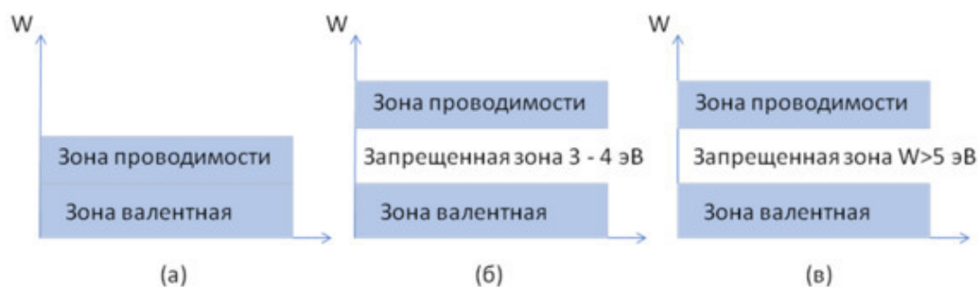
Рисунок 1.1 – Схемы зонной теории: (а) проводники; (б) собственные полупроводники; (в) диэлектрики
