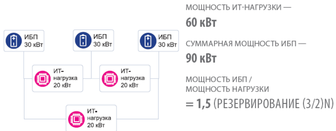
Рис. 4. Резервирование (3/2)N
