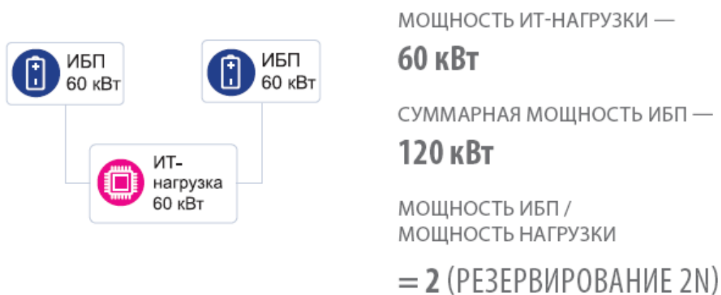
Рис. 3. Резервирование 2N
