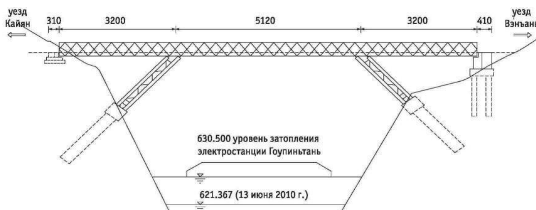
Схема транспортировочного моста Мяньюа в разрезе (ед. изм. габаритов: см, ед. изм. высоты м)
