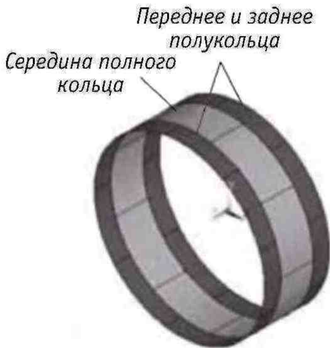
Рис. 4-4. Трехмерная модель оболочки-пружины
