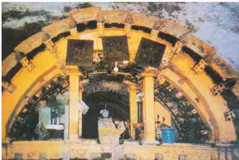
Рис. 1-38. Резуций проходческий щит (1986 г.)
