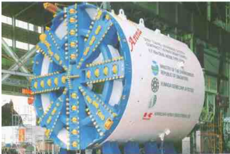
Рис. 6-27. Резцовая головка со спицами и червячной фрезой
