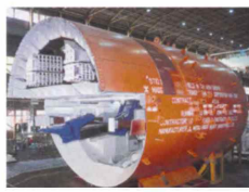
б) Щит с экскаваторным ИО в виде обратной лопаты диаметром 5.71 м
