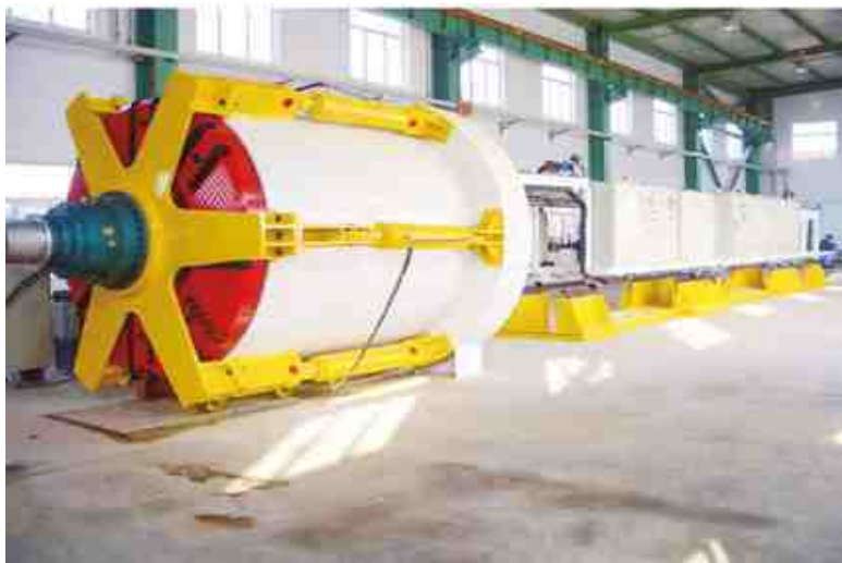
Рис. 1-46. Испытательная платформа для моделирования системы управления щитом гидropriгруза, разработанная Китайской железнодорожной корпорацией
