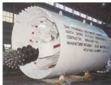
а) Щит со стреловым ИО диаметром 3.676 м
