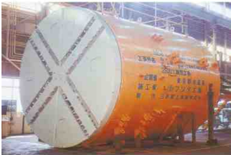
Рис. 1-10. Щит сжатого воздуха \varnothing 5.25 м
