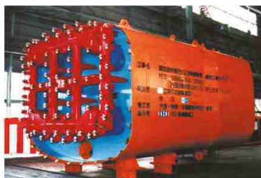
Рис. 2-9. Схематическое изображение принципов строительных работ эксцентрического многоосного проходческого щита
