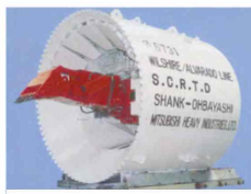
с) Щит с экскаваторным ИО в виде обратной лопаты диаметром 6.731 м
