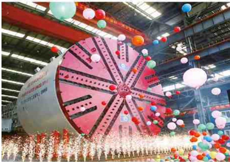
Рис. 1-50. Завершение изготовления проходческого щита с гидропригрузом большого диаметра
