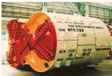
Рис. 2-17. Бициклический проходческий щит
