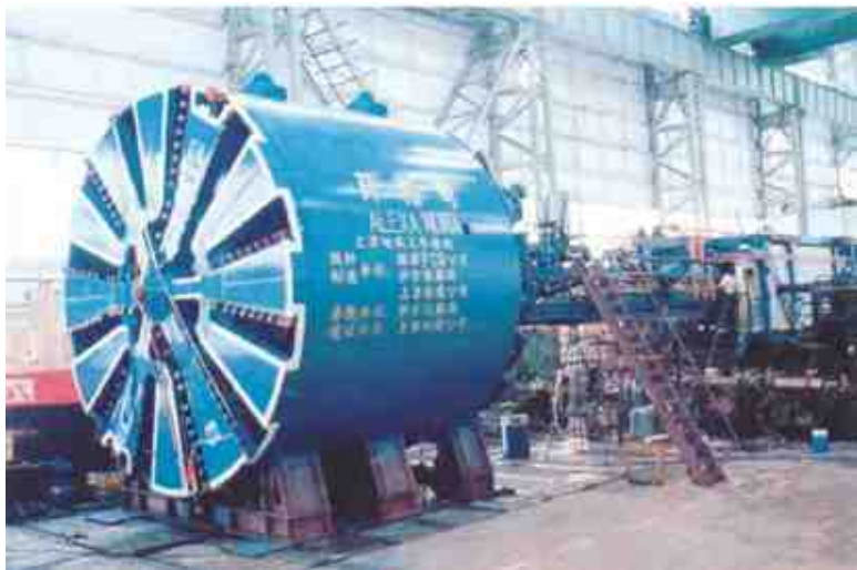
Рис. 1-42. 34-метровый щит, построенный совместно с судостроительным заводом Худун и FCB (Франция). Проходческий щит с грунтопригрузом «Введение в эксплуатацию» (1995 г.)
