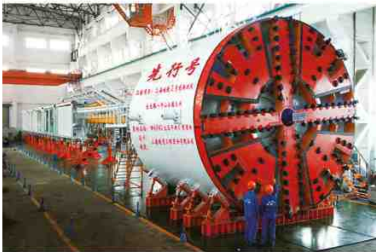
Рис. 1-44. Проходческий щит с грунтопригрузом с полностью независимыми правами интеллектуальной собственности «Совершенный».
