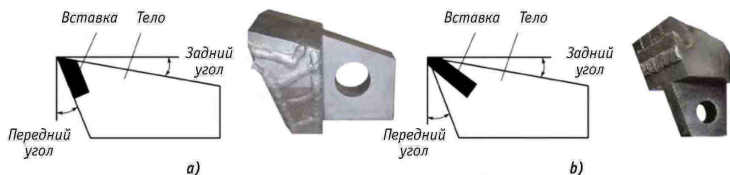
Рис. 6-5. Резак адгезионный и вставной: а) пайка сверху; б) в прорези
