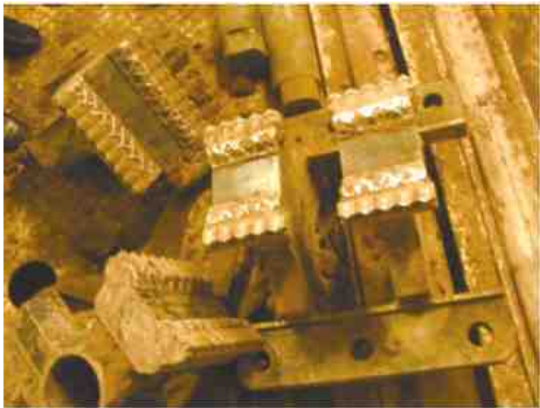
Рис. 6-7. Схематичное изображение главного и вспомогательного резка проходческого щита
