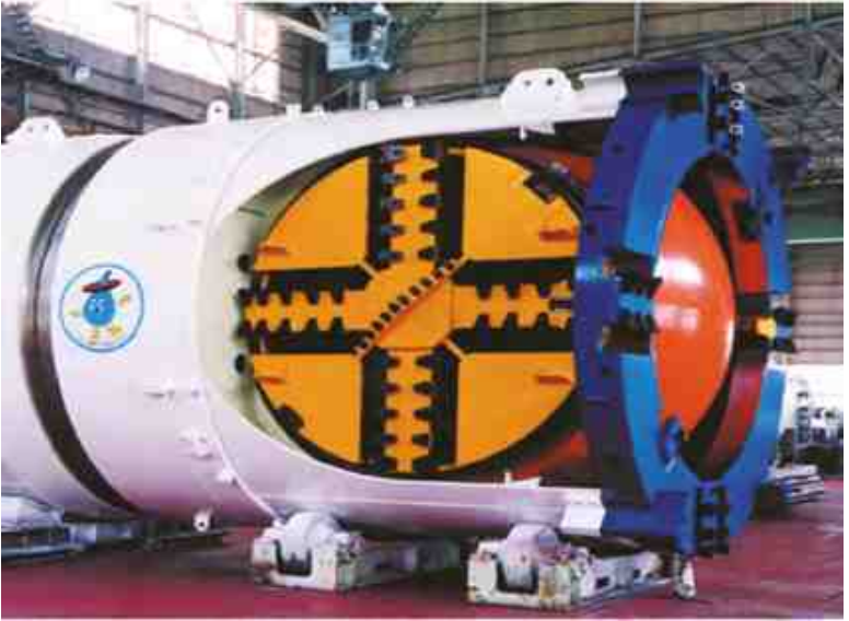
Рис. 2-14. Сферический проходческий щит
