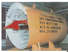
а) Щит с экскаваторным ИО в виде лопаты диаметром 2.86 м
