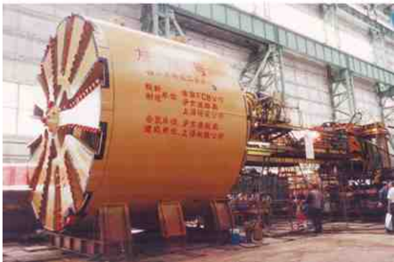
Рис. 1-41. 34-метровый щит, изготовленный совместно с судостроительным заводом Худун и FCB (Франция). Проходческий щит с грунтотриггузом «Дружба» (1990 г.)
