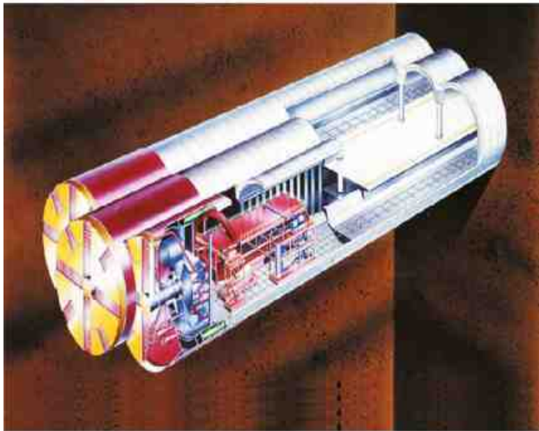
Рис. 2-11. Проходческий щит MF
