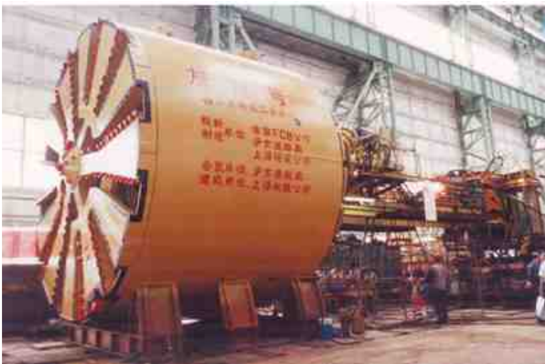
Рис. 1-41. 34-метровый щит, изготовленный совместно с судостроительным заводом Худун и FCB (Франция). Проходческий щит с грунтопригрузом «Дружба» (1990 г.)
