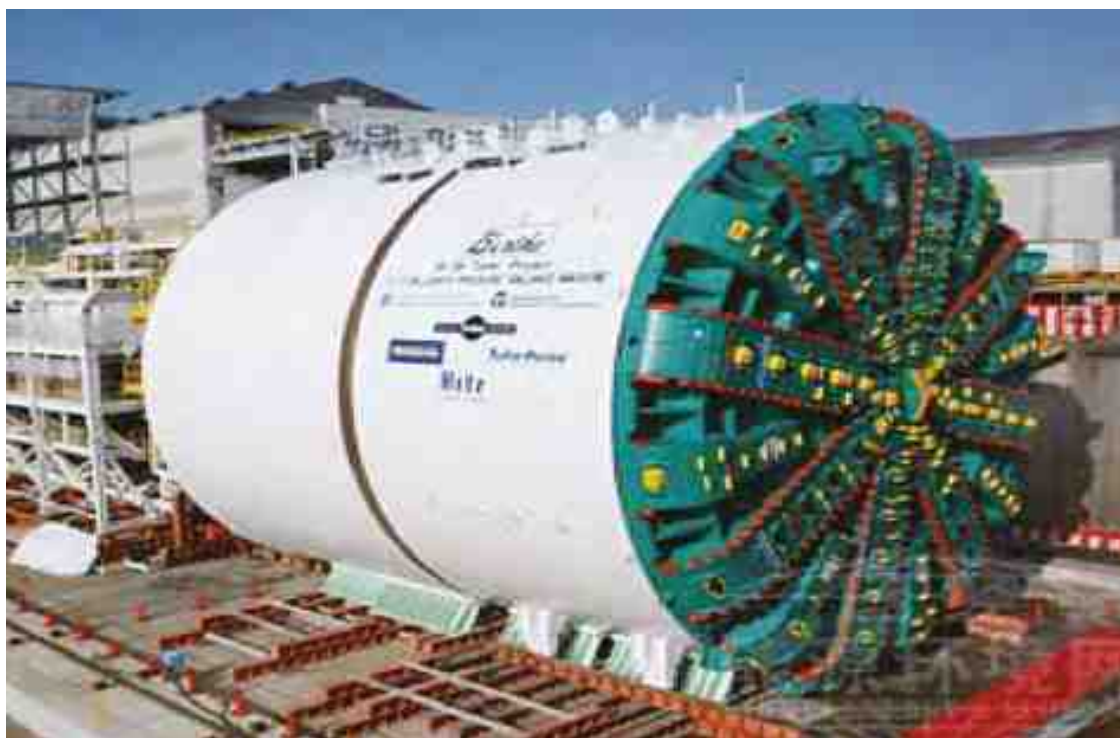
Рис. 1-1. Внешний вид проходческого щита
