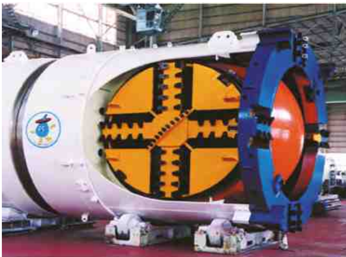
Рис. 2-14. Сферический проходческий щит
