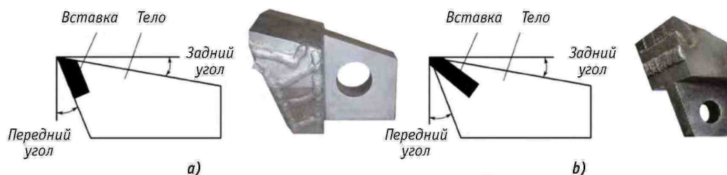
Рис. 6-5. Резак адгезионный и вставной: а) пайка сверху; б) в прорези
