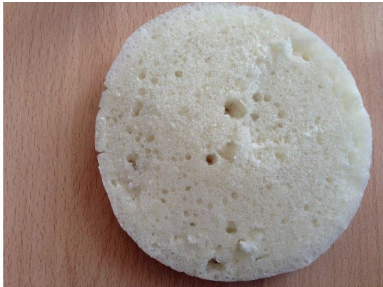
Рисунок 20. Срез образца бытовой пены №1. Диаметр образца 90 мм
