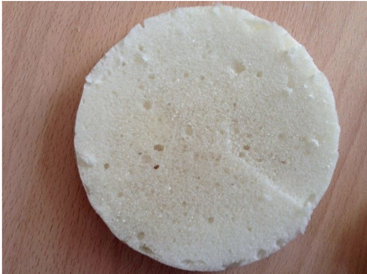
Рисунок 21. Срез образца бытовой пены №2. Диаметр образца 90 мм
