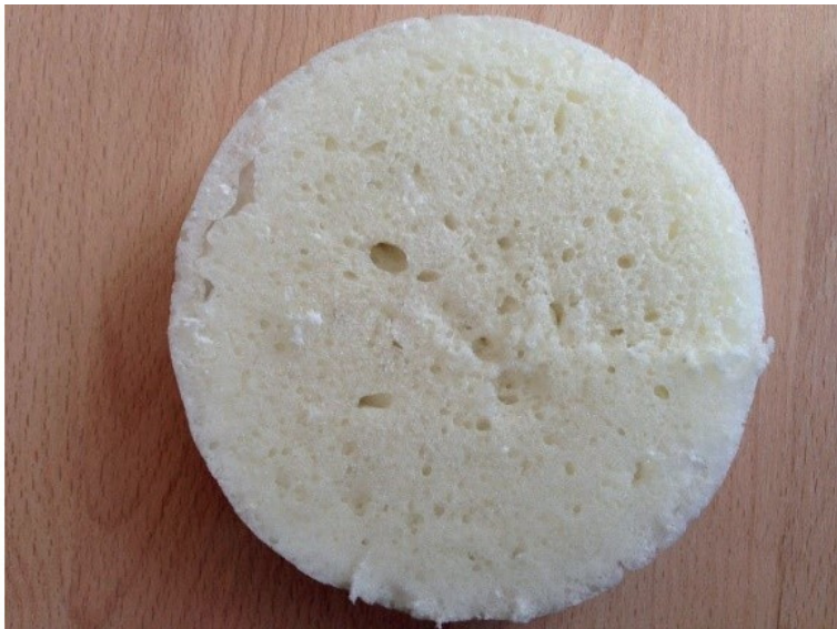
Рисунок 22. Срез образца бытовой пены №3. Диаметр образца 90 мм
