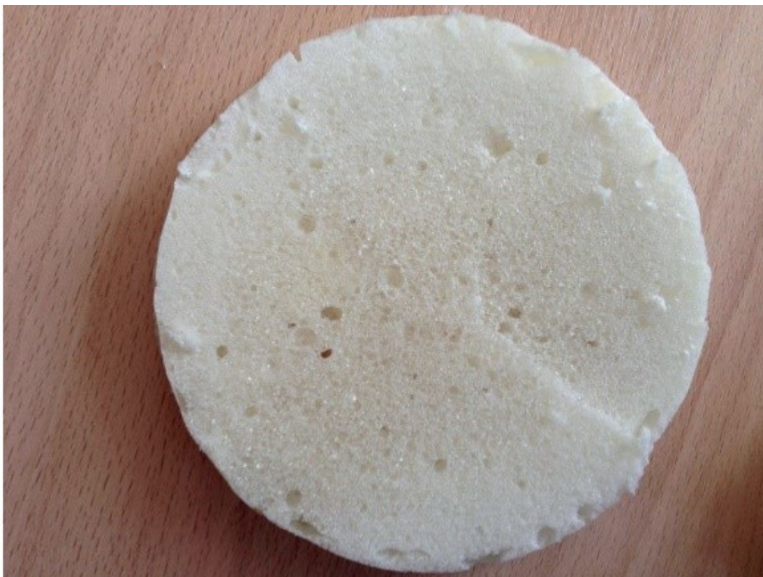
Рисунок 21. Срез образца бытовой пены №2. Диаметр образца 90 мм
