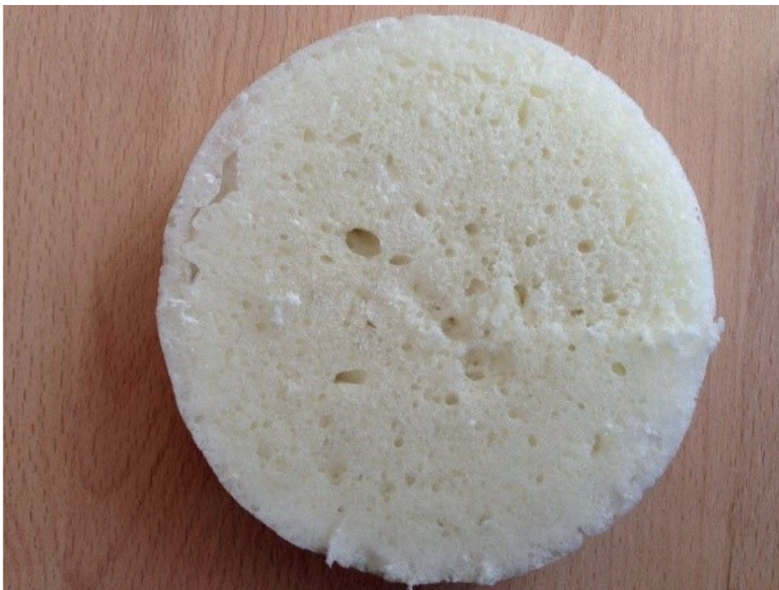
Рисунок 22. Срез образца бытовой пены №3. Диаметр образца 90 мм
