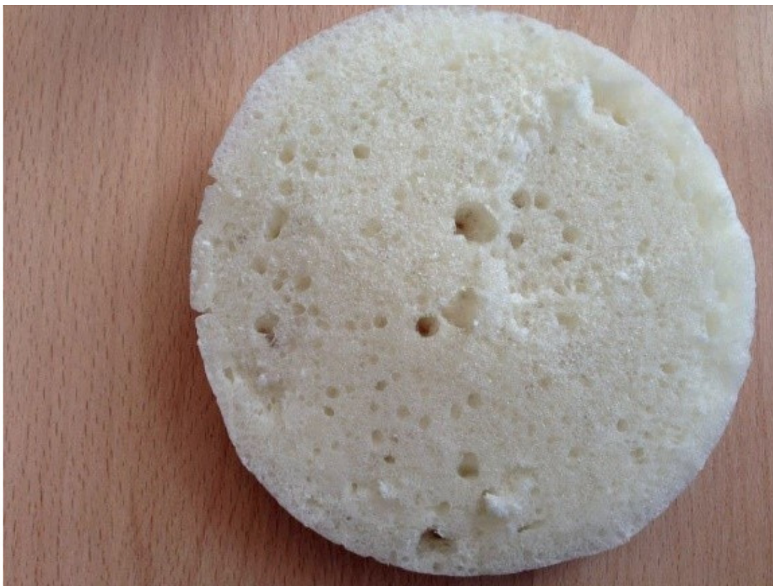
Рисунок 20. Срез образца бытовой пены №1. Диаметр образца 90 мм
