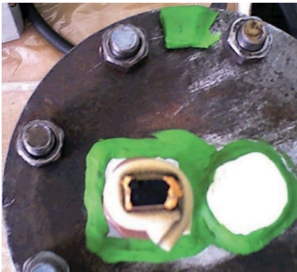
Рисунок 8. Система для определения распределения температур при подаче теплого воздуха в камеру
