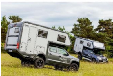
Рисунок 1.17. Слева: жилой модуль на пикап «WV Амарок» с жесткими стенами и крышей Немецкого производства. Справа — на ту же марку автомобиля установлен модуль с подъемной крышей, изготовленный в России.
