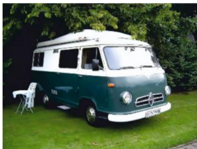
Рисунок 2.10. Автодом, «Caravano», созданный на шасси «Borgward B 611».
