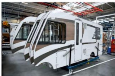
Рисунок 3.9. Слева: установка колесных арок на перевернутой панели пола автодома. Справа готовые боковые детали интегрированного автодома.
