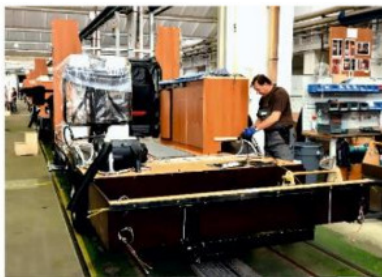
Рисунок 3.12. Установка основания багажного отделения: слева — на стандартную раму грузового шасси. Справа — на лонжеронную раму.
