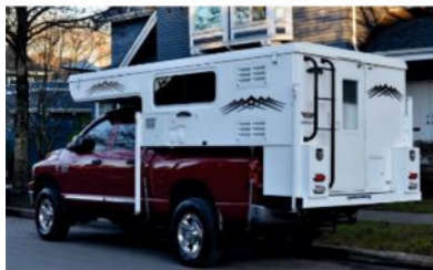
Рисунок 1.16. Жилой модуль на пикап с подъемной крышей. Слева — внутренний интерьер.
