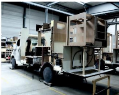
Рисунок 3.13. Слева: монтаж системы отопления, подключение газовой плиты и холодильника. Справа: монтаж кухонной зоны, душевой кабины с туалетом.
