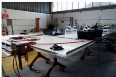
Рисунок 3.9. Слева: установка колесных арок на перевернутой панели пола автодома. Справа готовые боковые детали интегрированного автодома.
