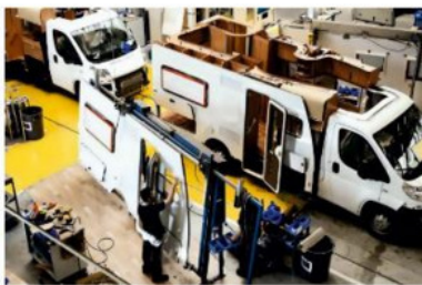
Рисунок 3.15. Слева монтаж стен на заводе бренда «Hymer Group» — «Carado», справа установка стен производства «Hobby».
