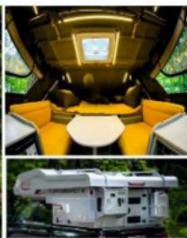
Рисунок 1.17. Слева: жилой модуль на пикап «WV Амарок» с жесткими стенами и крышей Немецкого производства. Справа — на ту же марку автомобиля установлен модуль с подъемной крышей, изготовленный в России.
