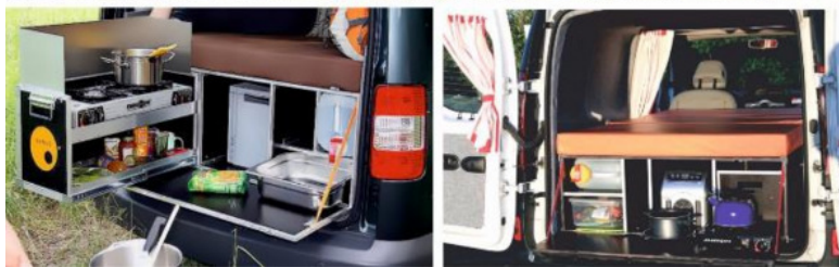
Рисунок 1.11. Городской грузовой фургон «Renault-Kangoo», с походным боксом для автопутешествий промышленного производства.
