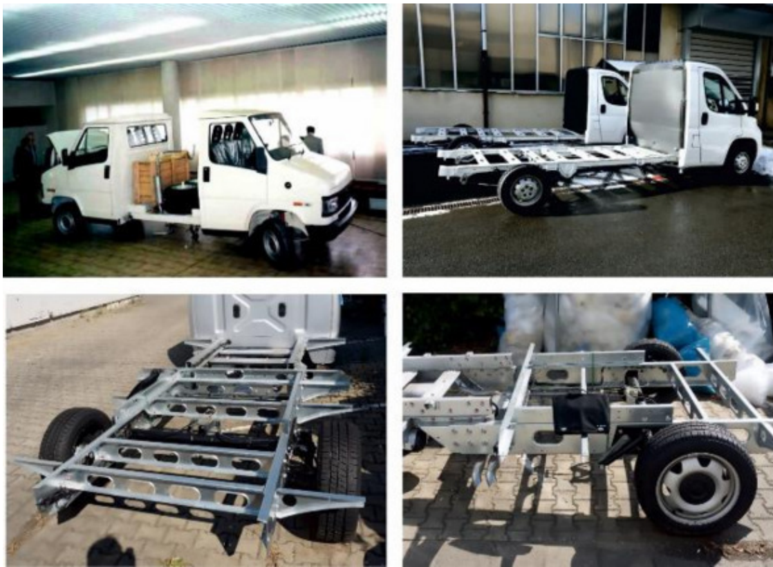
Рисунок 3.7. Шасси, которые поступают на производство автодомов. Сверху слева — только кабины. Сверху справа — рессорное шасси, без задней стенки для постройки автодома п/м более 3500 кг. Внизу — слева облегченное и расширенное шасси для автомобиля п/м менее 3500 кг. Внизу справа — пример скрепления шасси болтами.
