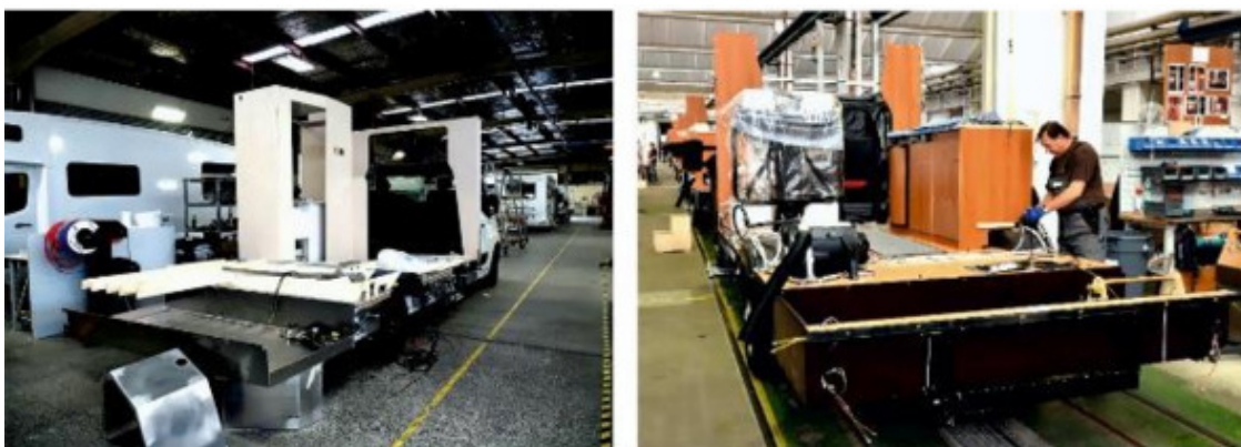
Рисунок 3.12. Установка основания багажного отделения: слева — на стандартную раму грузового шасси. Справа — на лонжеронную раму.
