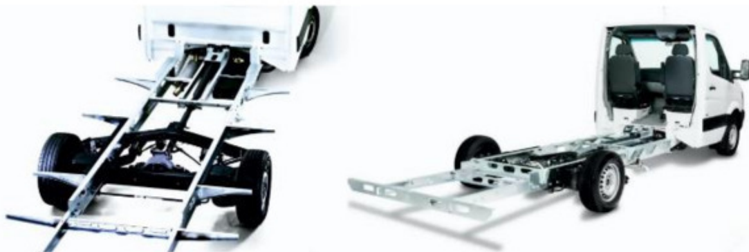
Рисунок 3.8. Заднеприводное шасси «Mercedes-Benz» подготовленное для производства автодома. Слева- на раме стороннего производителя. Справа — удлинение основной заводской рамы.
