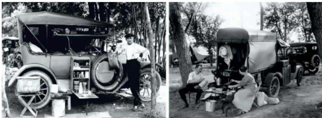
Рисунок 2.6. Переоборудованные из серийных автомобилей в дома на колеса модель «Т — Ford» пассажирский (слева) и грузовой (справа).
