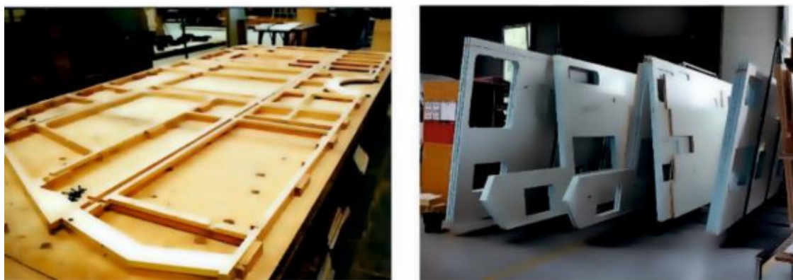
Рисунок 3.2. Слева- каркас из деревянных брусков стены каравана. Справа — готовые панели будущего «Vimobil».
