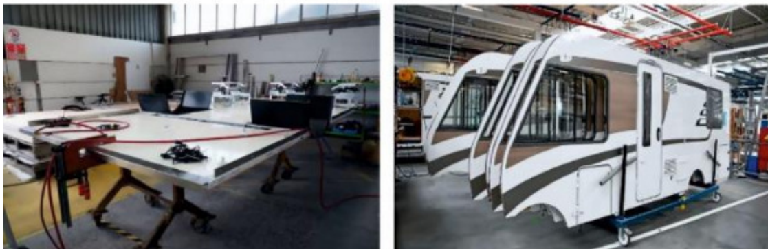
Рисунок 3.9. Слева: установка колесных арок на перевернутой панели пола автодома. Справа готовые боковые детали интегрированного автодома.
