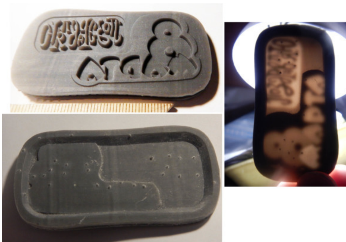
Фото 2.3.1. Пример черной непрозрачной детали толщиной в несколько миллиметров. В отраженном свете она абсолютно непрозрачная – глухая. Но достаточно посмотреть сквозь нее на настольную лампу... чтобы убедиться, что она просвечивает.
