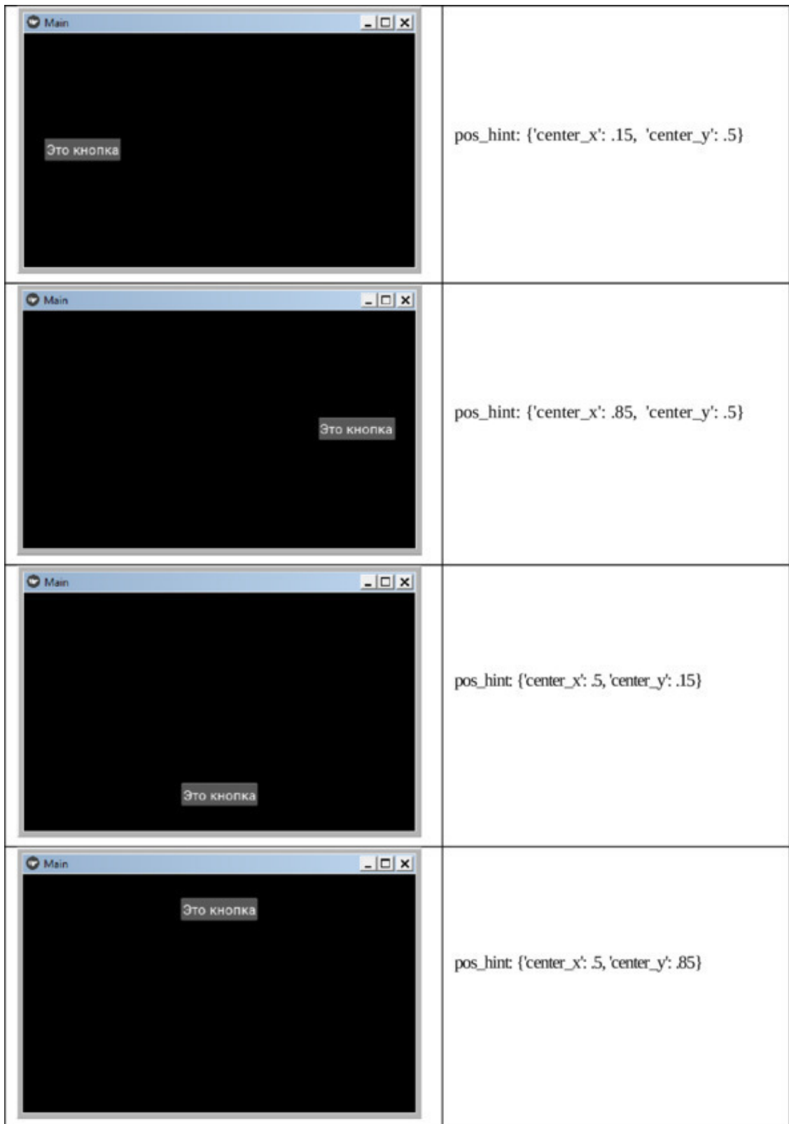
Рис. 2.35. Положение кнопки в различных частях окна приложения
