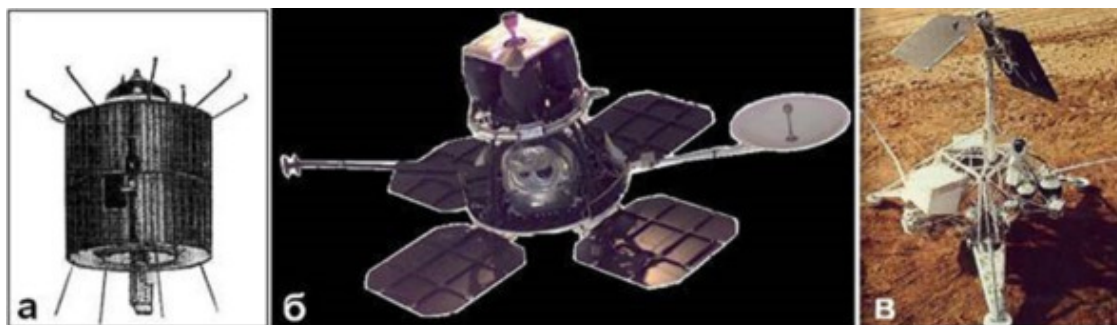
Илл.2. Автоматы подменили астронавтов: а) высотный околоземной спутник АТС-3, б) окололунный спутник «Орбитер», в) аппарат мягкой посадки на Луну «Сервейер». [2] В дей-
