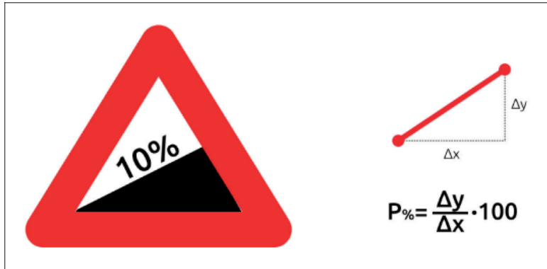
Figura 1.26 – Cartel que indica una pendiente del 10 % y grafía para el cálculo de la pendiente.
