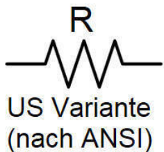
Abb. 7: Die Schaltzeichen eines Widerstandes
