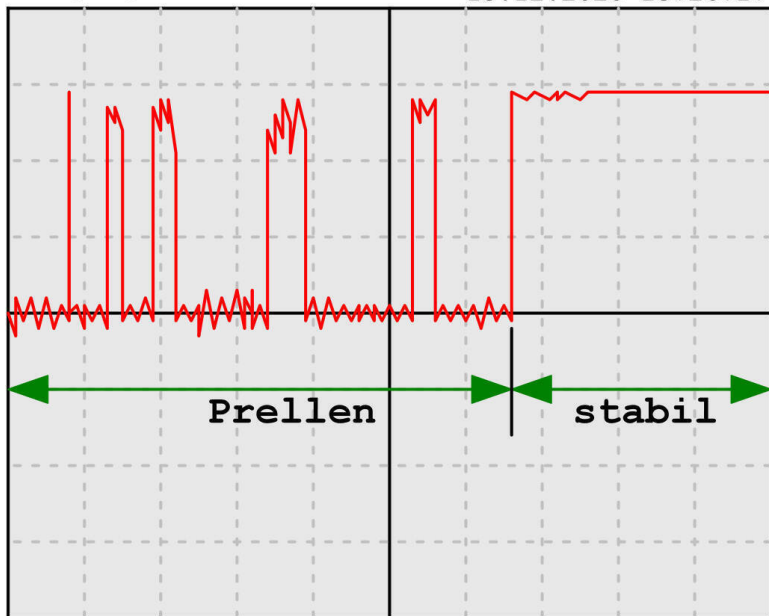
Abb. 1: Ein prellender Taster – Schlimmer Finger!
