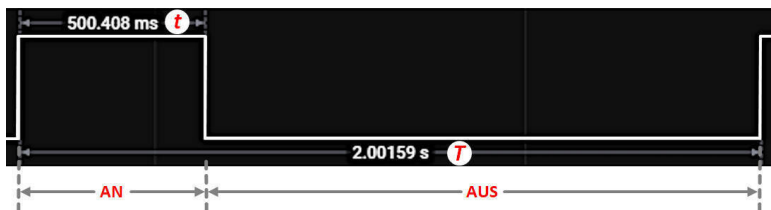
Abb. 8: Der Verlauf des Pegels am digitalen Ausgang Pin 13 bei einem Tastgrad von 25%
