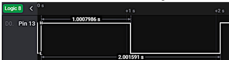
Abb. 4: Der Verlauf des Pegels am digitalen Ausgang Pin 13 Achtung!
