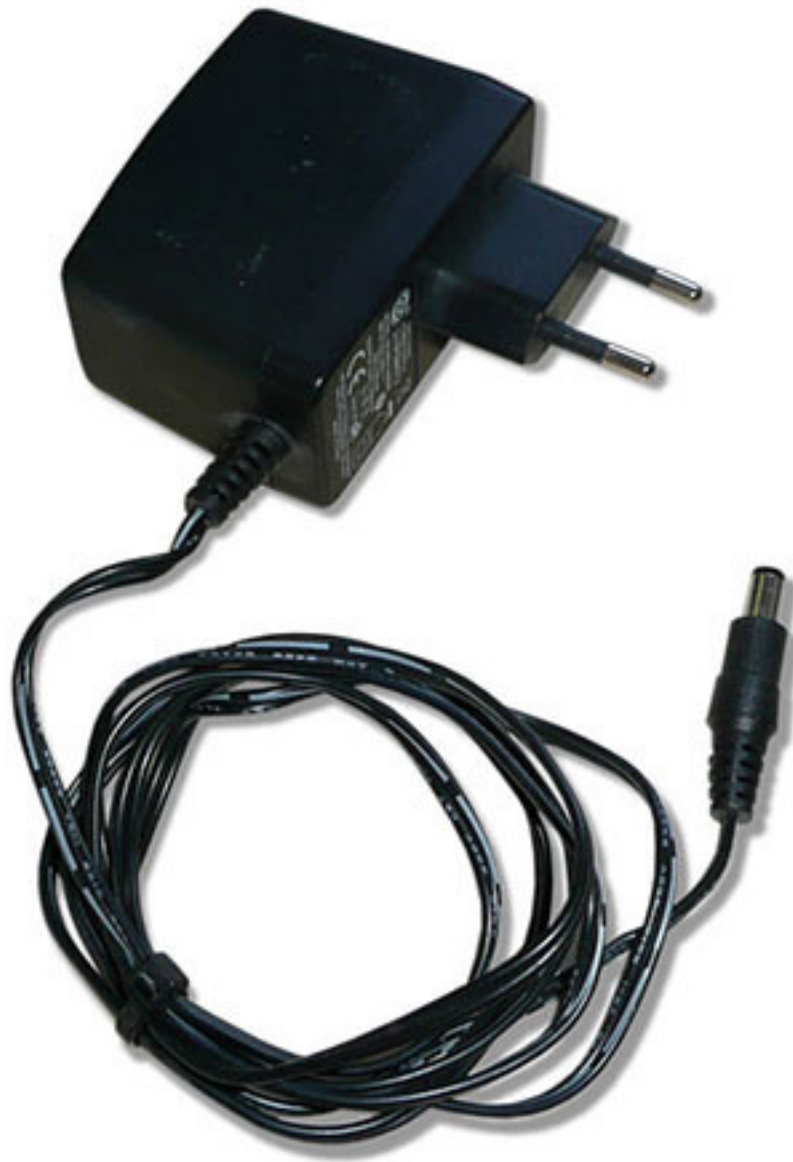
Abb. 4: Eine Spannungsversorgung mit einem Steckernetzteil
