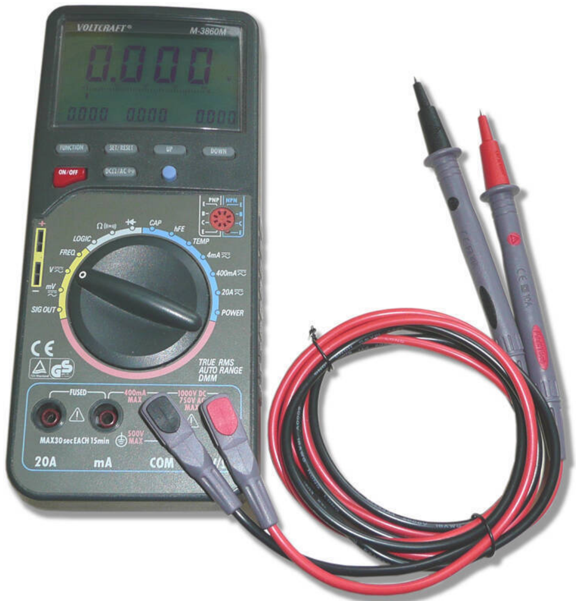
Abb. 21: Ein Vielfachmessgerät – Multimeter
