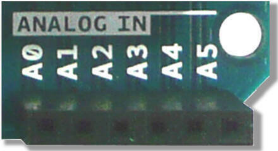
Abb. 14: Die analogen Eingänge
