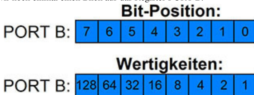
Abb. 8: Der Schaltplan für unser kleines Lauflicht Werfen wir noch einmal einen Blick auf das Register PORT B.
