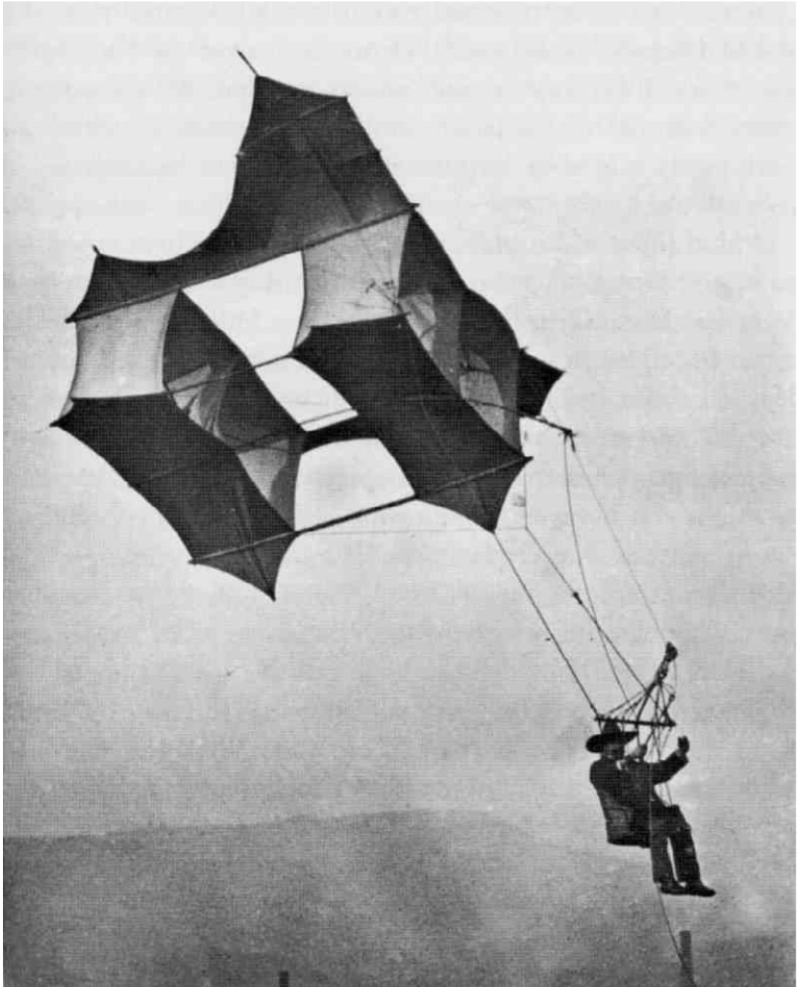
Um protótipo de papagaios que surgiu por volta de 1901. Foi desenvolvido por Francis Rogallo, nos EUA, e tinha asas numa versão alada da pipa celular capaz de levantar um homem.
