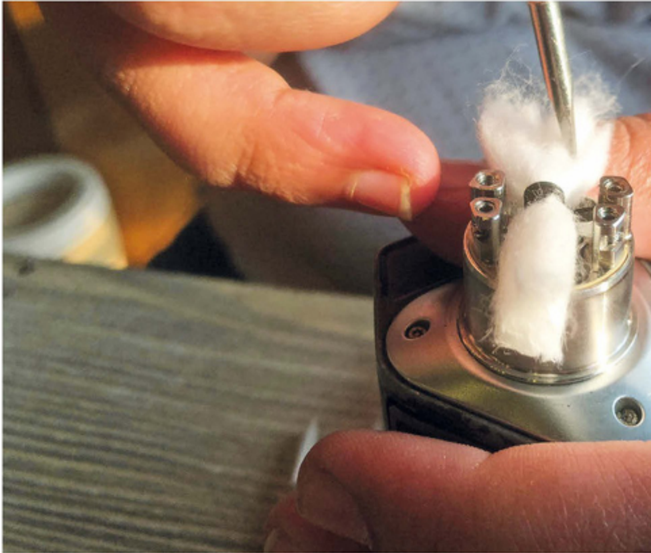
Abbildung 6: Selbstwickelverdampfer mit Wicklung (Drahtspule und Watte)
