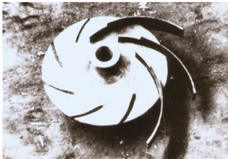
Рис. 1.27. Сборка лопастей с ведущим диском рабочего колеса центробежного насоса БНДв
