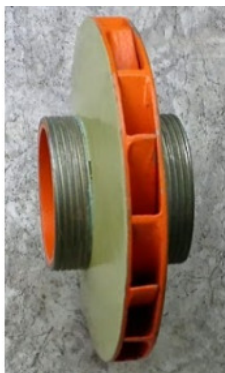
Рис. 1.41. Сварное рабочее колесо с лопастями, имеющи-
