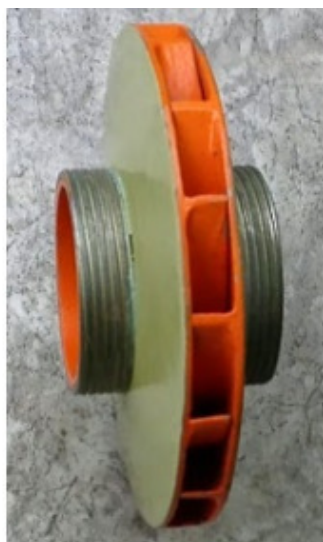
Рис. 1.41. Сварное рабочее колесо с лопастями, имеющими укороченный профиль
