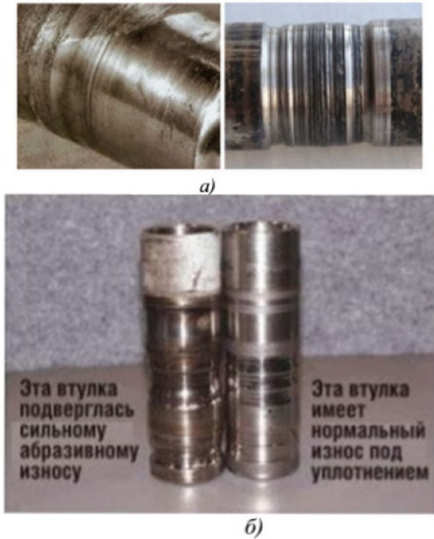
Рис. 1.10. Абразивный износ под сальниковой набивкой: а) вала; б) защитных втулок вала насоса [17]
