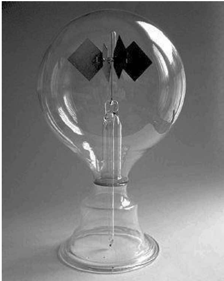
Радиометр Крукса – вертушка с четырьмя лопастями, которая вращается под действием света.
