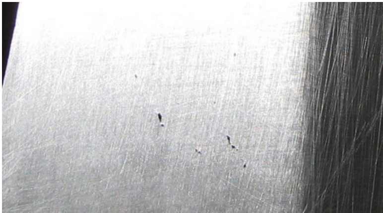
Рис. 2.1. Раковины на беговой дорожке внешнего кольца двухрядного роликового подшипника
