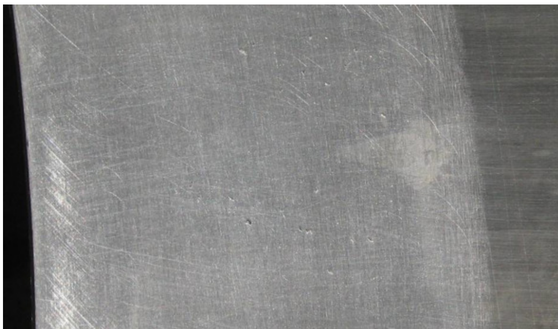
Рис. 2.1. Раковины на беговой дорожке внешнего кольца двухрядного роликового подшипника
