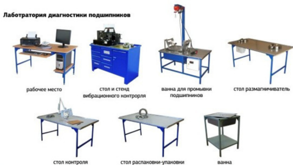
Рис. 2.11. Лаборатория диагностирования подшипников на основе стенда СКВ-А
