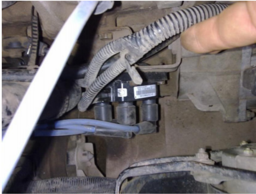
Новые провода и новый модуль зажигания
