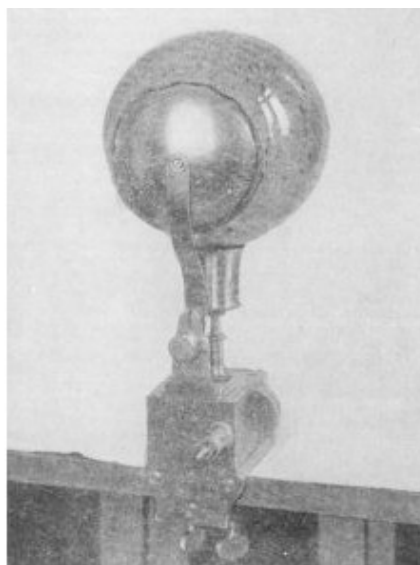
Рис 7. Электрическая машина Кулибина образца 1772 г., по [20]
