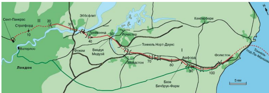
Схема высокоскоростной линии Лондон – тоннель под Ла-Маншем (I и II – участки строительства)
